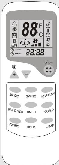
1. Pressione o botão TURBO durante a operação RESFRIAMENTO ou AQUECIMENTO, a velocidade do ar será ajustada em ALTA.
