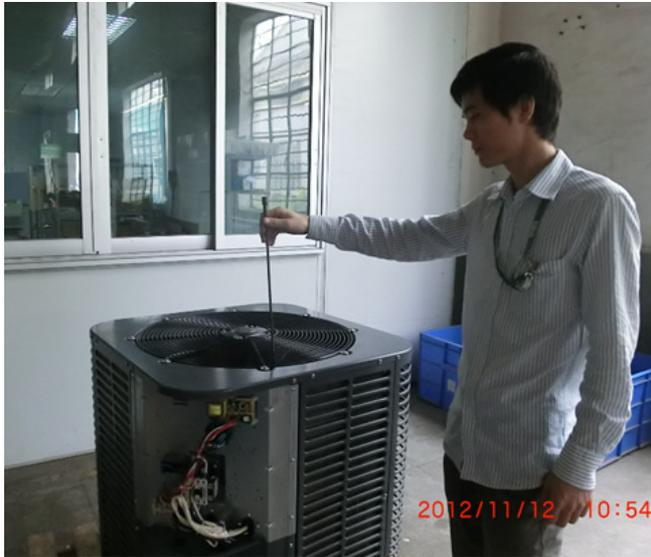
Check the fan blade can move or not
